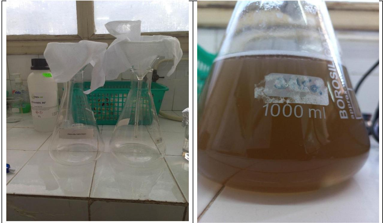
**Figure 10 : Filtration de mucilage extrait de graines de lin.**
