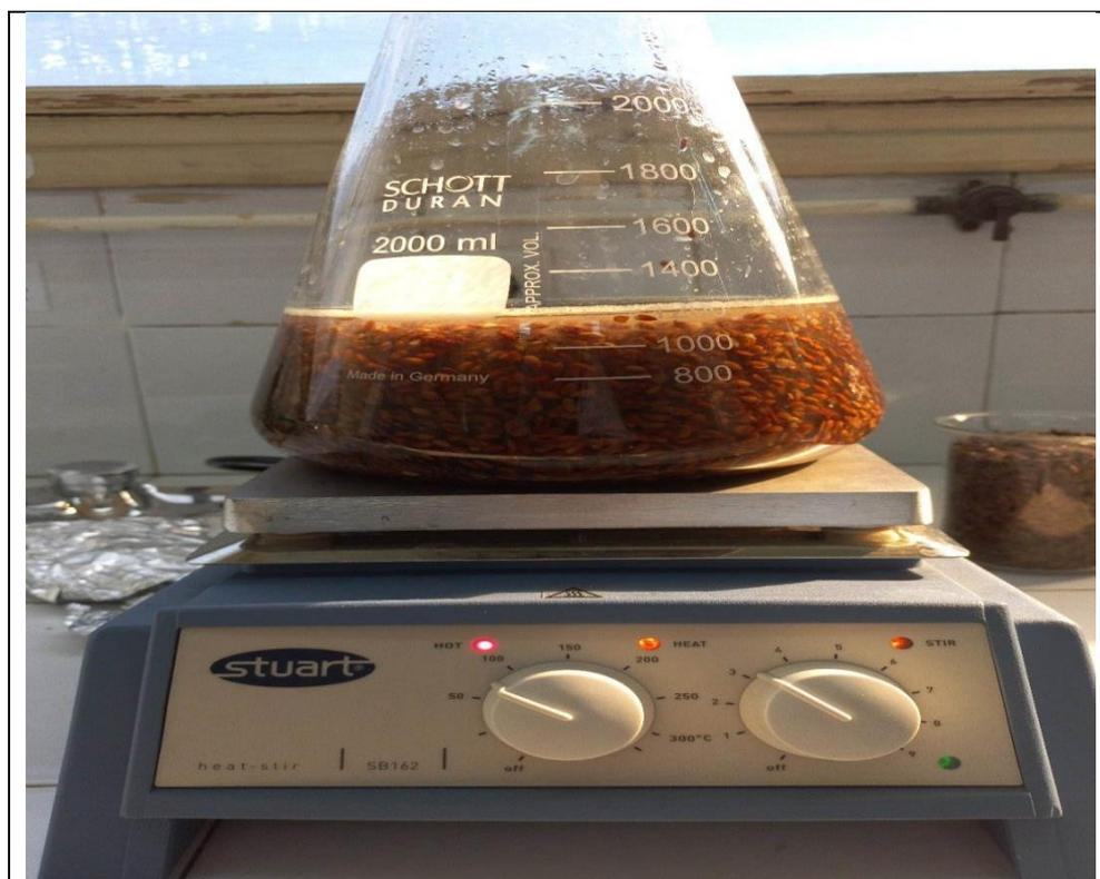
Figure 9 : Extraction du mucilage a partir de graines de lin.
